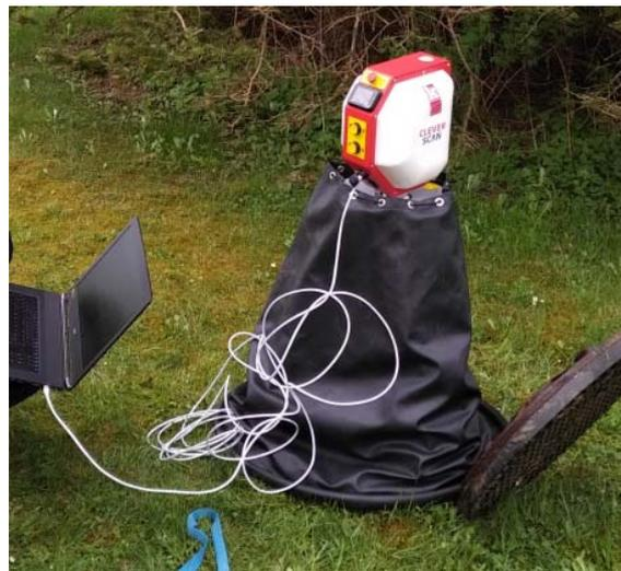
Abbildung 32: CleverScan beim Scanvorgang einer Hauspumpstation mit herkömmlichen Schachtabmessungen.
